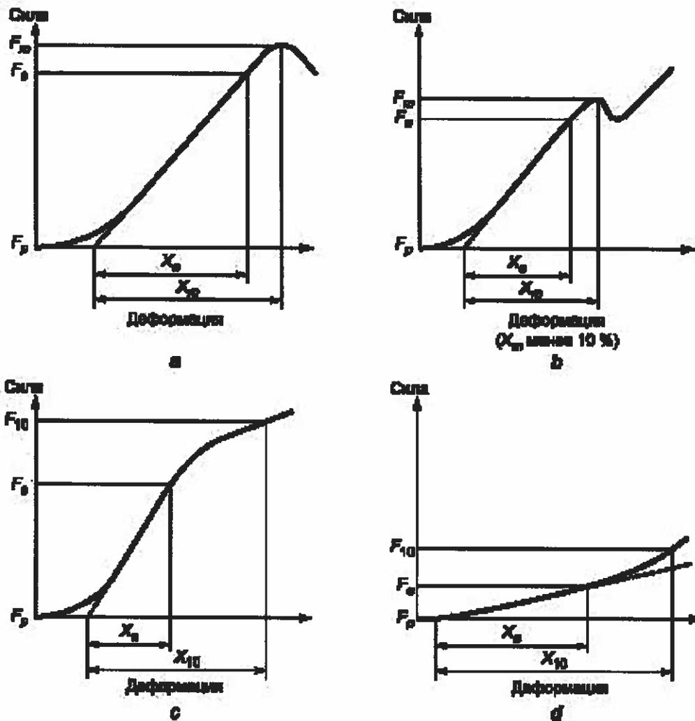
$F_p$  — сила, соответствующая предварительной нагрузке;  $F_m$  — максимальная сила;  $X_m$  — деформация при максимальной силе;  $F_{10}$  — сила при относительной деформации, равной 10 %;  $X_{10}$  — относительная деформация, равная 10 %;  $F_0$  — сила, соответствующая деформации  $X_0$  (условный прямо пропорциональный предел);  $X_0$  — деформация в условно упругой зоне (верхняя граница условно упругих деформаций)
